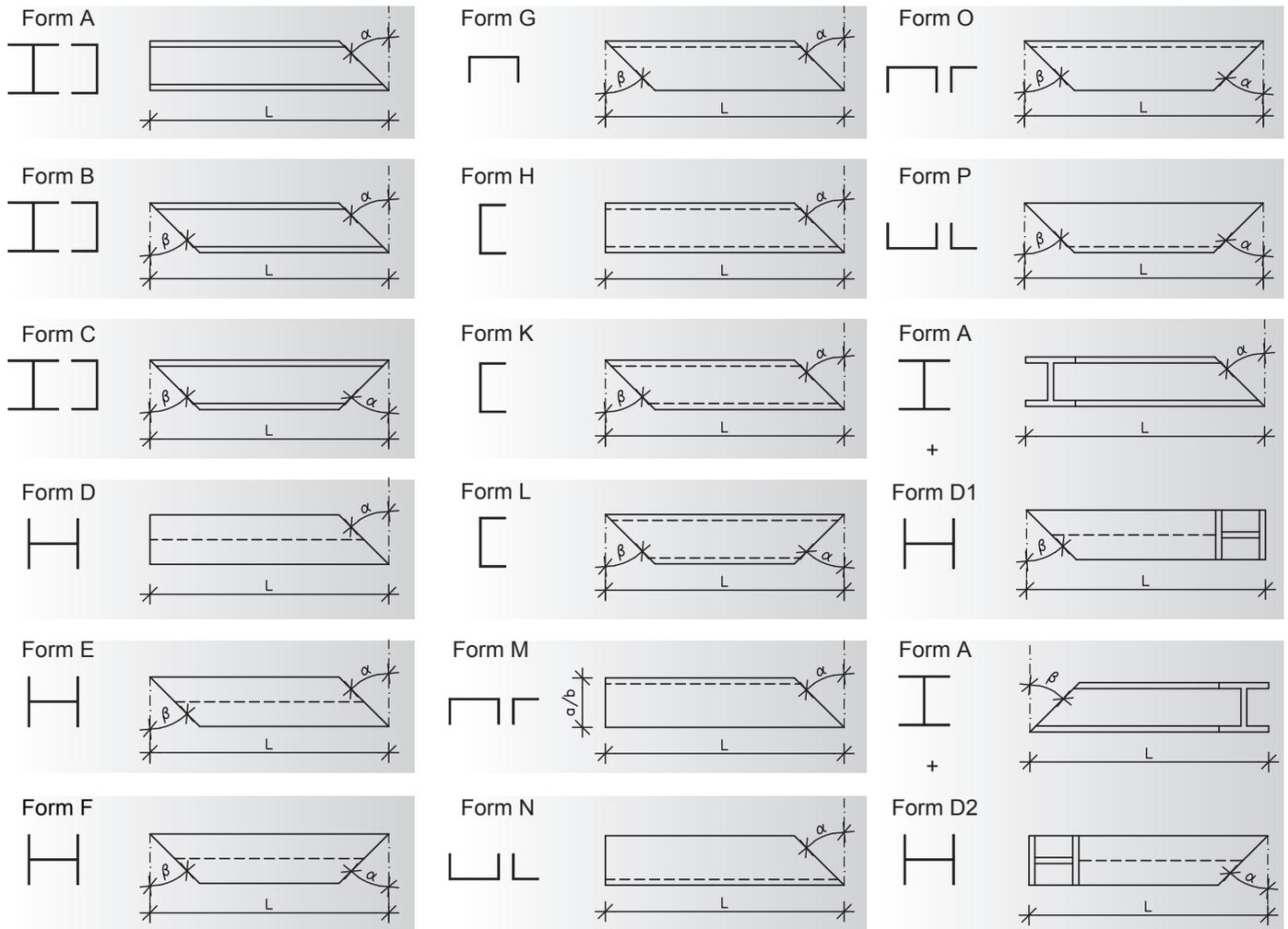
Bei ungleichschenkligen Winkeln (Form M-P) muss wie im Beispiel Form M der sichtbare Schenkel (a / b) bemaßt werden.
